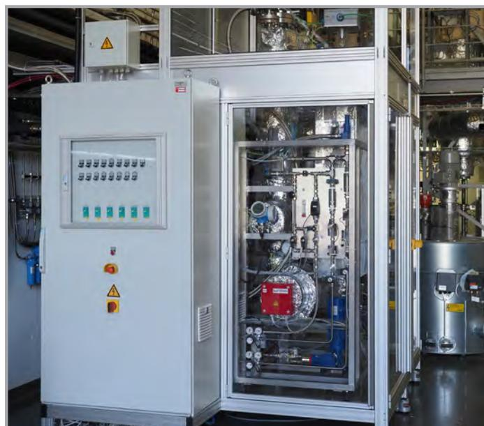
Plattenreaktor zur Methanisierung im Aufbau (oben) und als Modul für den Einsatz in der Tankstelle der Zukunft (unten)
