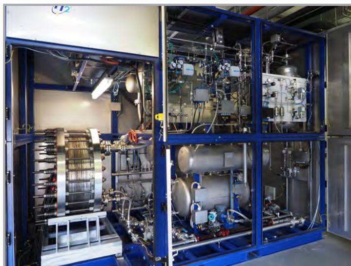
Abb. 2: Alkalischer Druckelektrolyse-Teststand mit 100 kW Block (links) Quelle: ZSW
